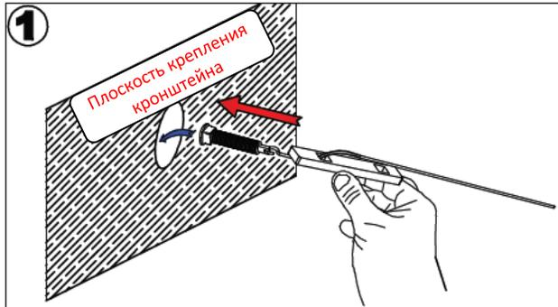
Вставьте в крепежное отверстие болт с надетой на проволоку планкой.
