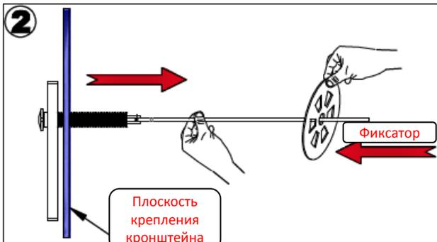
Потяните за проволоку. Болт и планка встанут в рабочее положение. Фиксатором зафиксируйте закладную планку.
