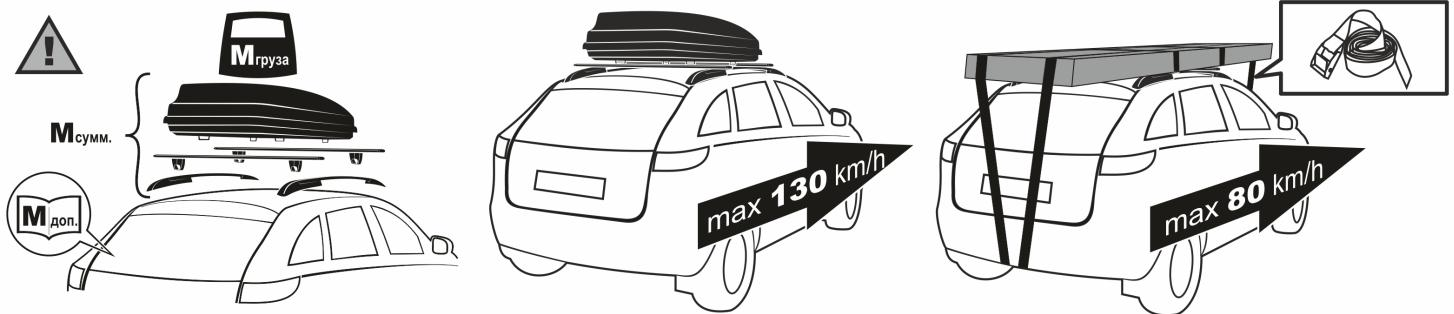
Скорость движения с габаритным и тяжелым грузом не должна превышать 80км/ч, и ни при каких прочих условиях скорость автомобиля с грузом не должна превышать 130км/ч.
