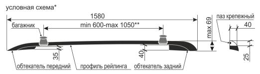
\*внешний вид изделия отличается от представленного на схеме \*\* в зависимости от типа крепления поперечин багажников
