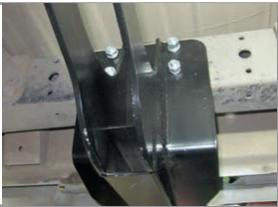
**ШАГ 3.** Закрепите кронштейн сварной на круглой балке с помощью кронштейна гнутоого, соединив обе детали с помощью двух болтов M10x1,25x40 через шайбы на 10 и гроверы на 10, гайками M10x1,25, и болтов M12x1,25x45 через шайбы 12 и гроверы 12, гайками M12x1,25 снизу, как показано на схеме.
