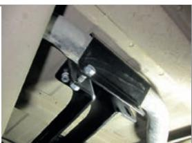
**ШАГ 4.** Отрегулируйте положение сварного кронштейна и затяните все резьбовые соединения.
