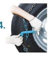
5. Запорное кольцо завести в паз запорного гака. При необходимости произвести дополнительную натяжку цепи (перецепить запорный крюк и гак за следующие хвостовые звенья). Продольные и поперечные ветви должны плотно захватить шину.
