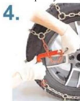
5. Запорное кольцо завести в паз запорного гака. При необходимости произвести дополнительную натяжку цепи (перецепить запорный крюк и гак за следующие хвостовые звенья). Продольные и поперечные ветви должны плотно захватить шину.
