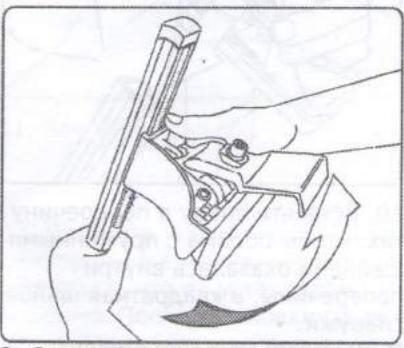
3. Опору багажника сместите в сторону центра дуги до упора в линейку. Поверните опору, тем самым зафиксировав ее на дуге.
