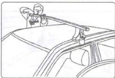
6. Руководствуясь этими наклейками, установите багажник в сборе на крышу автомобиля. Убедитесь в том, что багажник установлен на крыше ровно (проверьте спереди).
