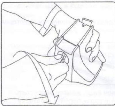
3. Поворотом ключа по часовой стрелке на угол  $\approx 90^\circ$  откройте замок.
