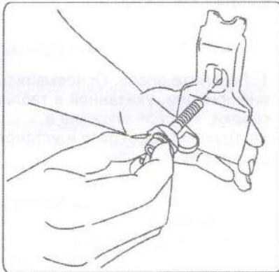
6. Выберите прижим на основании информации, указанной на наклейке, расположенной непосредственно на прижиме. Вставьте болт в паз прижима.
