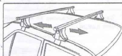
13. Потяните установленный багажник из стороны в сторону, чтобы убедиться, что он установлен надежно. После установки груза на поперечины багажника, проверьте еще раз надежность и прочность его крепления и при необходимости подтяните винты.
