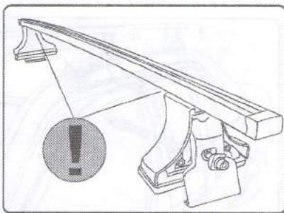
5. Для определения местоположения опор на крыше руководствуйтесь информацией на наклейках, размещенных на нижней стороне дуг или на прижимах.
