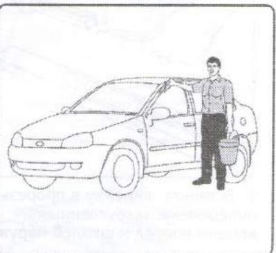
4. В местах установки опор багажника очистить крышу автомобиля от загрязнений.
