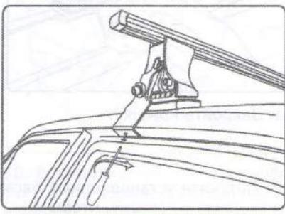
8. Если в дверных проемах (и, соответственно, в прижимах багажника) автомобиля предусмотрены отверстия для крепления багажника, необходимо закрепить прижимы винтами, находящимися в комплекте поставки.
