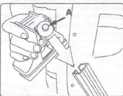
10. Вставьте опору в поперечину так, чтобы обойма с пружинными шайбами оказалась внутри поперечины, а квадратная шайба снаружи.
