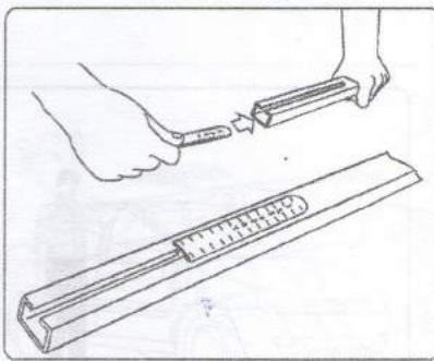
9. Вставьте линейку в прорезь поперечены закругленным концом вперёд и шкалой наружу.
