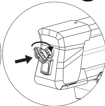
1 Перед установкой лыжного крепления, снять верхние резиновые уплотнители поперечин:
