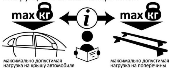
! Перед каждой поездкой проверяйте надёжность крепления багажника и бокса к поперечинам!
