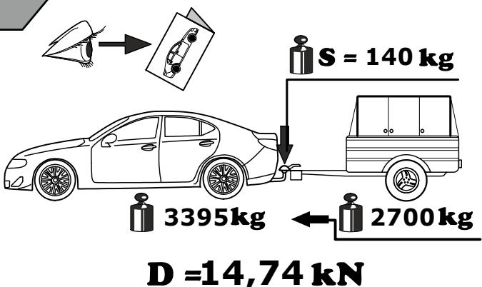
**⚠ Max вес прицепа без тормозной системы = 750 кг.
