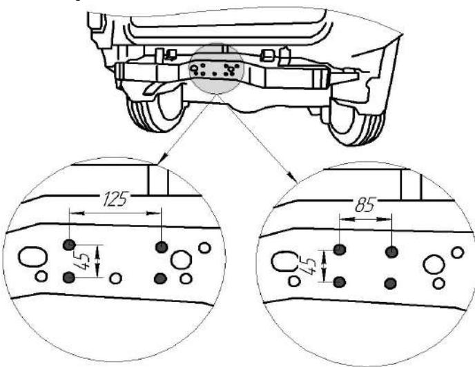
**5** Закрепите вставку в сборе (1) на передней стенке балки рамы с помощью крепежных изделий (14,19,18) или с помощью крепежных изделий (13,18,19) и закладной пластины (4) в зависимости от комплектации авто.
