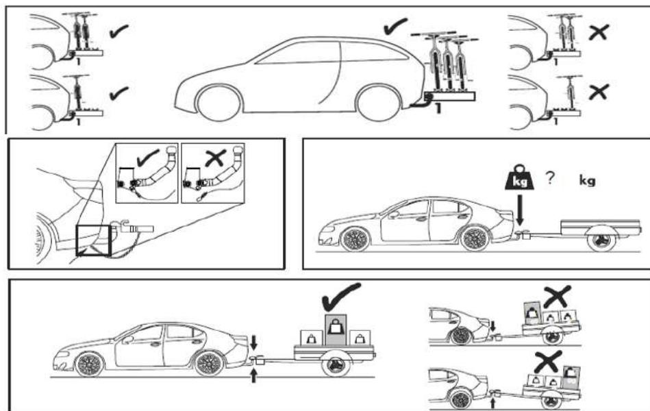
**ВНИМАНИЕ:** В процессе движения по дорогам общего пользования, неровн время остановок проверяйте крепление багажной системы!
