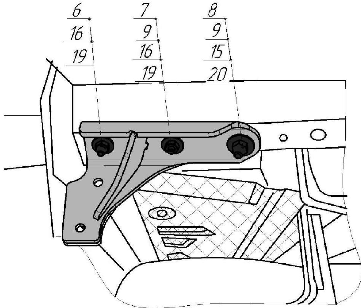
**4** Закрепите балку (1) к кронштейнам (2,3) с помощью крепежных изделий как указано на схеме.
