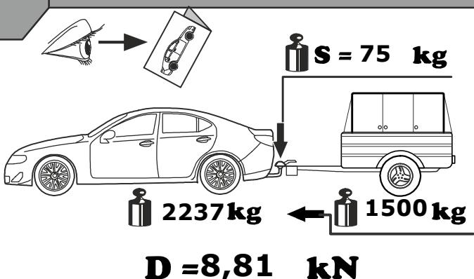
**⚠ Max вес прицепа без тормозной системы = 750 кг.**
