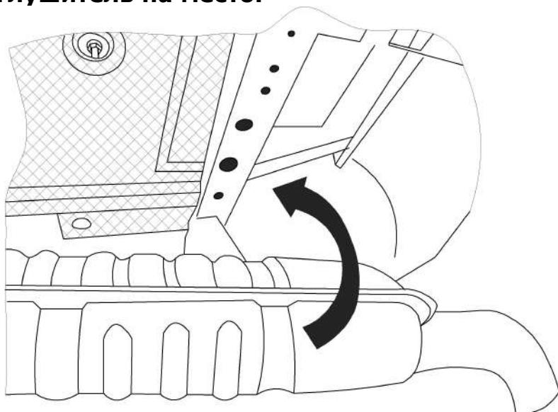
**7** Закрепите шар (4) между дистанционными пластинами (5) с кронштейном розетки (10) с помощью крепежных изделий показанных на схеме.
