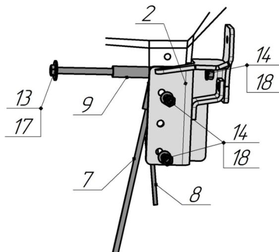
4. Установите правый кронштейн (3) и буксировочную петлю с помощью крепежных изделий (9,13,14,17,18), (12,16,18) и (14,18), как указано на схеме. Под буксировочную петлю подложите шайбы (19,20).
