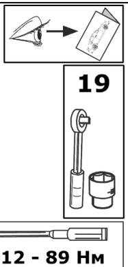
7. Установите шар с помощью крепежных изделий (11,15,18) как указано на схеме.
