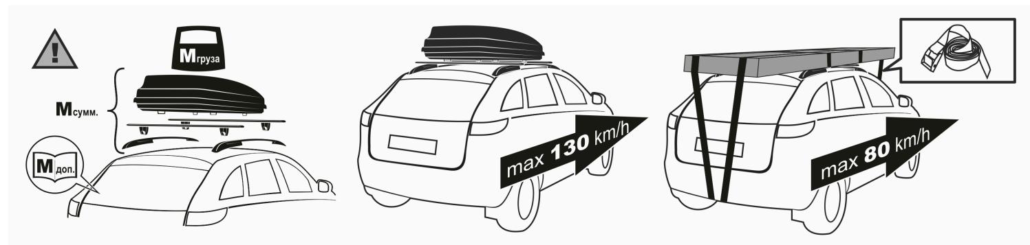
Скорость движения с габаритным и тяжелым грузом не должна превышать 80км/ч, и ни при каких прочих условиях скорость автомобиля с грузом не должна превышать 130км/ч.
