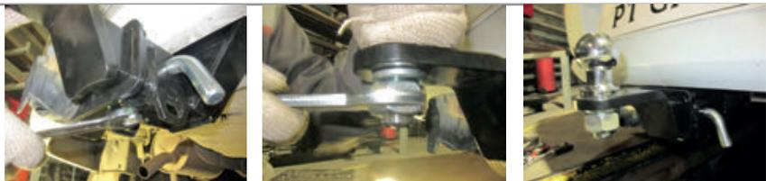
**ШАГ 5.** Установите фиксирующий болт М10х20 снизу, он используется для исключения технологических люфтов съемного шара и только в ненагруженном состоянии! Перед сцепкой болт демонтировать! Установка завершена!
