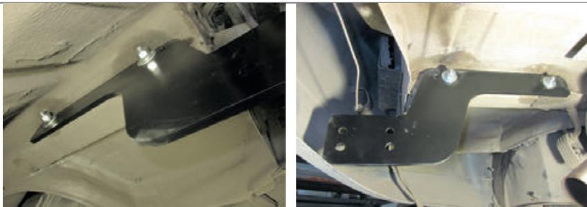
**ШАГ 3.** Установите балку ТСУ с помощью болтов М10х1,25х40 через шайбы 10 с помощью гаек М10х1,25.
