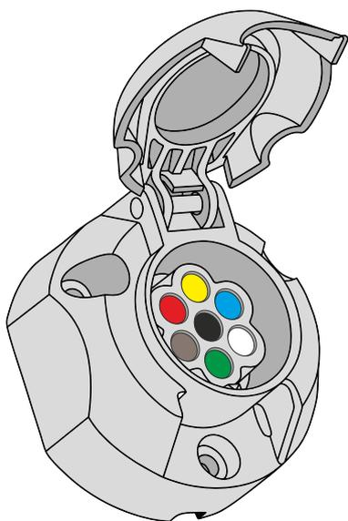
Проведите проверку сигналов, выходящих на розетку тягово-сцепного устройства при запуском, а затем - на заглушенном двигателе автомобиля.
