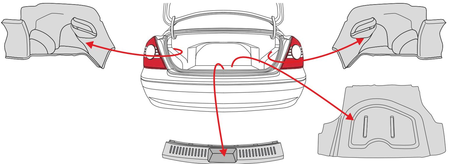
Элементы обшивки, которые рекомендуем демонтировать перед установкой комплекта проводки.
