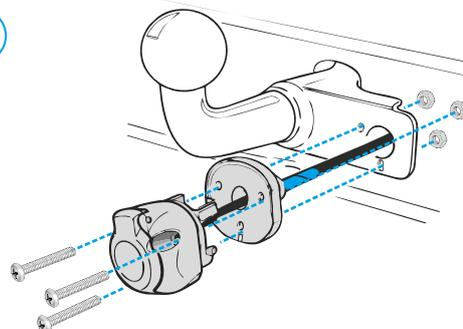
Закрепите розетку и пыльник на монтажной поверхности.
