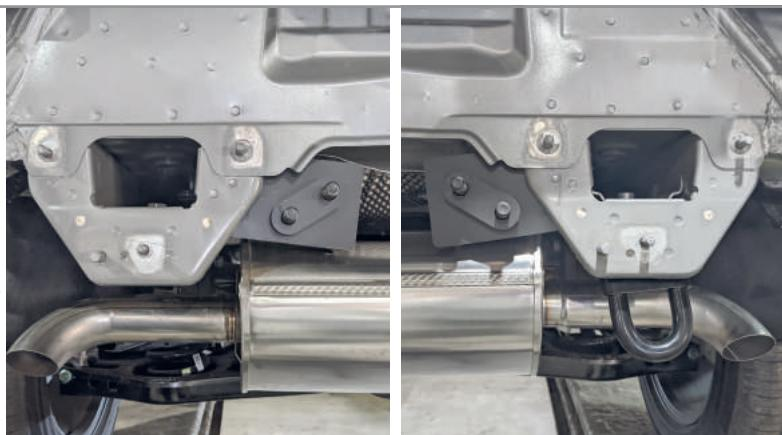
**ШАГ 2.** Установите глушитель обратно на крепления. Совместите отверстия в балке со шпильками на лонжероне автомобиля и со шпильками в кронштейнах и зафиксируйте ее положение при помощи метизов из поставки - гайки M12x1,25, шайбы 12 и шайбы 12 гроверные. Установите ранее демонтированный усилитель заднего бампера, совместите отверстия в усилителе со шпильками на лонжероне и зафиксируйте положение при помощи ранее демонтированных штатных метизов.
