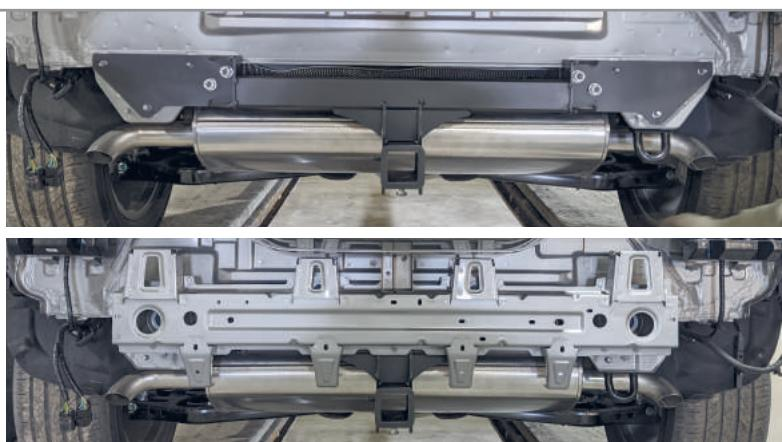
**ШАГ 3.** Установите съемный шар в сборе и закрепите его пальцем гнутым гальванизированным со шплинтом пружинным игольчатым. Затяните шар ключом на 38 мм. Установите фиксирующий болт M10x20 снизу, он используется для исключения технологических люфтов съемного шара и только в ненагруженном состоянии! Перед сцепкой болт демонтировать!
