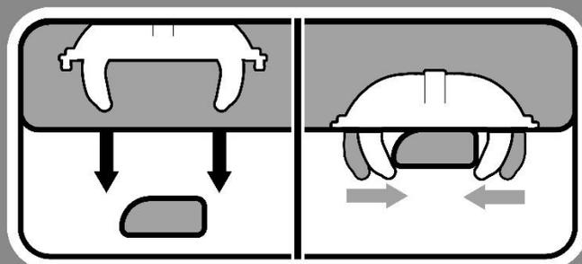
Максимально закрутите крепление до полного сжатия «лапок» на поперечинах.
