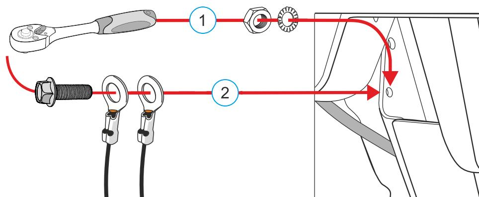
При подключении клеммы «масса» убедитесь, что рекомендуемое место установки не имеет следов коррозии и окисления, а также прочих загрязнений.
