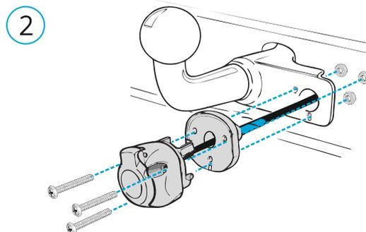
Закрепите розетку и пыльник на монтажной поверхности.
