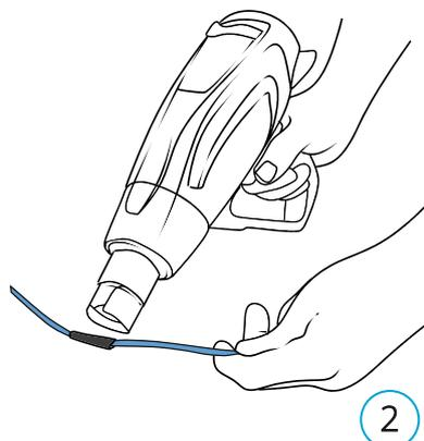
1. С помощью строительного фена нагревайте термоусадочную трубку.
