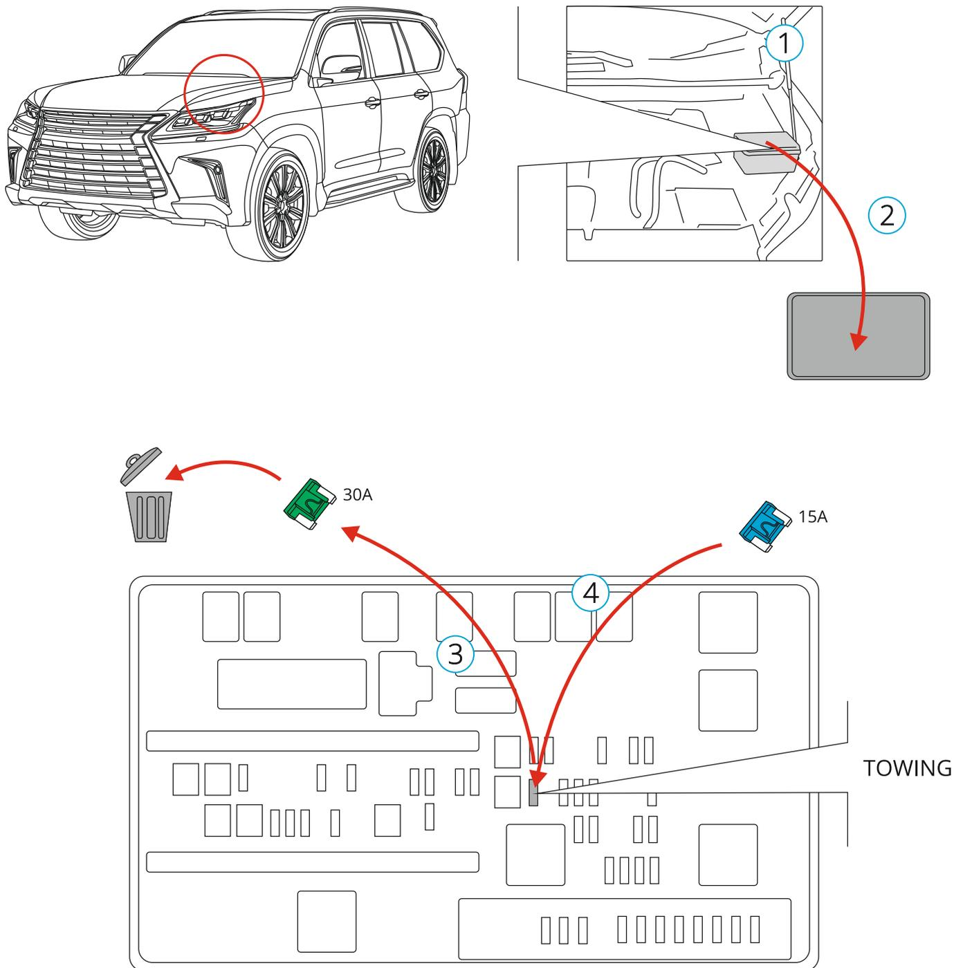
Для того, чтобы произвести замену предохранителя, отвечающего за питание блока, необходимо:
