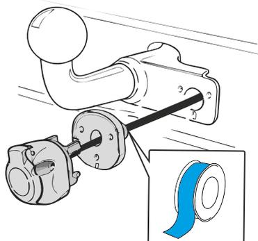
Герметично заизолируйте соединение между пыльником и жгутом провода розетки.
