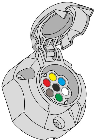
Проведите проверку сигналов, выходящих на розетку тягово-сцепного устройства при запуске, а затем - на заглушенном двигателе автомобиля.
