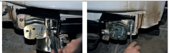
**ШАГ 4.** Затяните все болты в следующей последовательности: сначала затяните кронштейны между собой, затем болты в нижней части лонжеронов, потом болты крепления опор усилителя заднего бампера.
