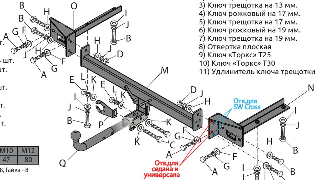
Table with 3 columns: Диаметр резьбы (M8, M10, M12), Момент затяжки, Нм (24, 47, 80)
