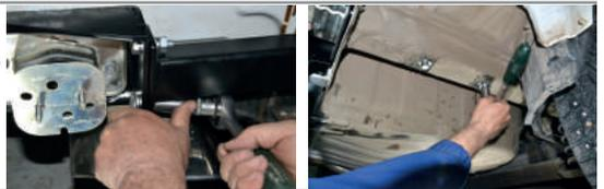
**ШАГ 5.** Установите усилитель заднего бампера на штатные метизы. Установите задний бампер и задние фонари согласно инструкции по ремонту автомобиля. Зафиксируйте положение крюка и подраетника, соединив их отверстия с отверстиями на «ушах» балки и закрепив их болтами M12x1,25x80, шайбами 12, шайбами 12 гроверными и гайками M12x1,25.
