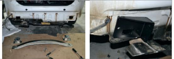
**ШАГ 2.** Закрепите кронштейны в нижней части лонжеронов болтами M10x1,25x40 через шайбы 10 увеличенные и гроверы 10.
