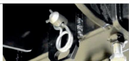
**ШАГ 5.** Затяните шар с помощью ключа на 38 мм. Вкрутите стопорный винт M10x20 снизу, он используется для исключения технологических люфтов съемного шара и только в ненагруженном состоянии!
