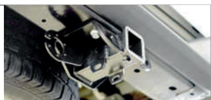
**ШАГ 4.** Установите съемный шар в сборе и зафиксируйте его с помощью пальца гнутого и шплинта.
