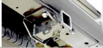
**ШАГ 3.** Установите кронштейн розетки закрепив его четвёртым болтом **M12x1,25x45 с юбкой\***.
