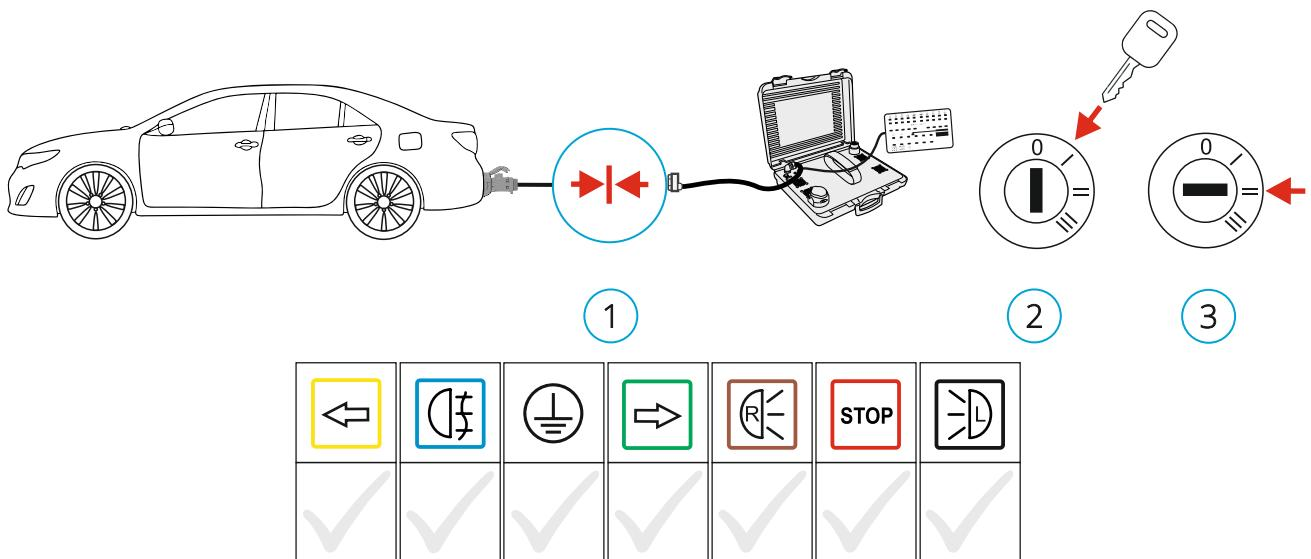
Проведите проверку сигналов, выходящих на розетку тягово-сцепного устройства при запущенном, а затем - на заглушенном двигателе автомобиля.
