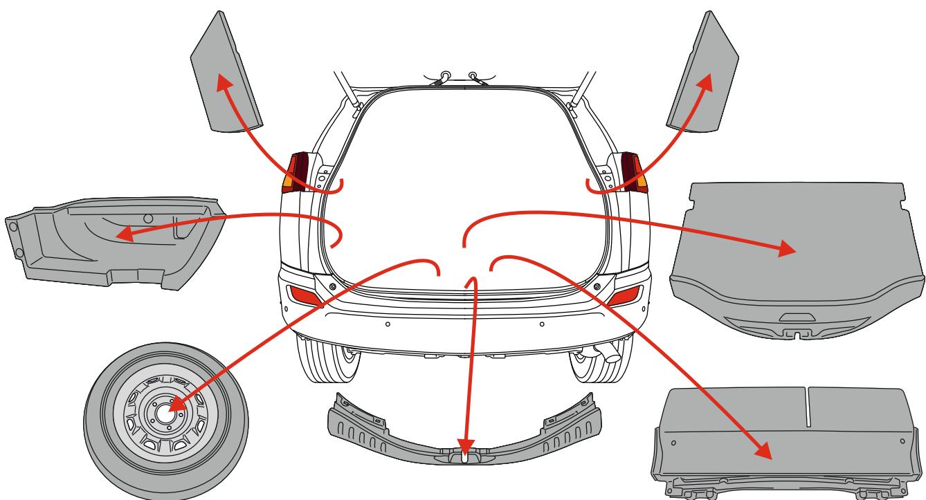
Элементы обшивки, которые рекомендуем демонтировать перед установкой комплекта проводки.
